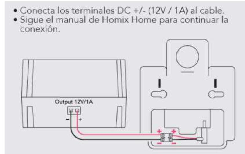
1. Se pueden usar los cables del antiguo termostato para llevar corriente continua a Homix Home. Compruebe siempre el estado correcto de los cables y el diámetro.
