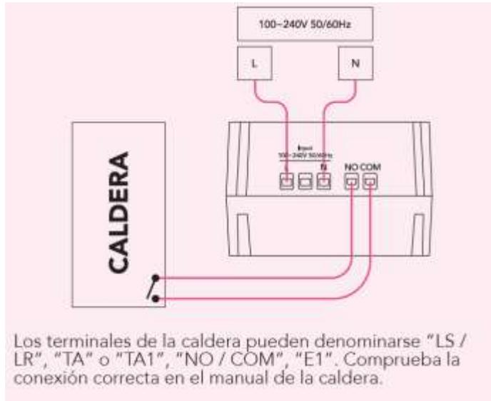
1. Instale el módulo de caldera en una caja externa (no suministrado) o en una caja de conexiones.
