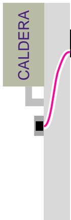
Sustitución de termostato. Con el **Relé** instalado cerca de la caldera y utilizando los cables del antiguo termostato para conectar Homix Home a la corriente.
